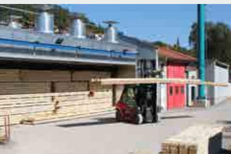
Durch die technische, computergesteuerte Trocknung wird die Holzfeuchtigkeit schonend auf ca. 15 % (bei MH-Natur® ≤ 20 %) reduziert. Bei einer Holztemperatur von ca. 65 °C über mehrere Tage hinweg, **ist ein späterer Befall des verbauten Holzes durch holzerstörende Insekten, in den Nutzungsklassen 1 und 2 unwahrscheinlich.** Bestätigt hat dies eine in Deutschland und Österreich durchgeführte Feldstudie.
