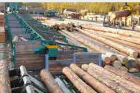
Versierte Fachleute sortieren das Rundholz für die spätere Verwendung. Besonderer Wert wird auf einen zentrischen Kern und einen höchst geringen Buchsanteil (Rothärte) gelegt. Grobastige oder drehwüchsige Stämme werden aussortiert.
