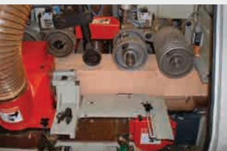
Auf CNC-gesteuerten Hochleistungshobelanlagen werden die Konstruktionsvollhölzer von MH®-MassivHolz auf allen vier Seiten sauber gehobelt und gefast. Eine letzte visuelle Sortierung nach optischen und statischen Kriterien beendet den Herstellungsprozess.
